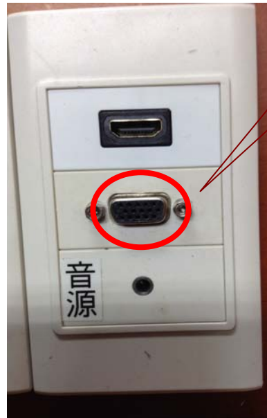
圖 2 NB 外接 VGA 線連接
